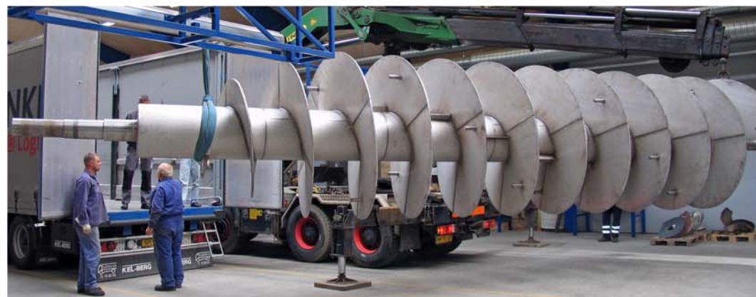
Efter afslibning og færdiggørelse læsses sneglen på bil. Samlet vægt for sneglerotor ca 7500kg.
