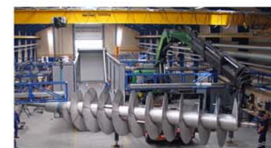
Efter afslibning og færdiggørelse læsses sneglen på bil. Samlet vægt for sneglerotor ca 7500kg.
